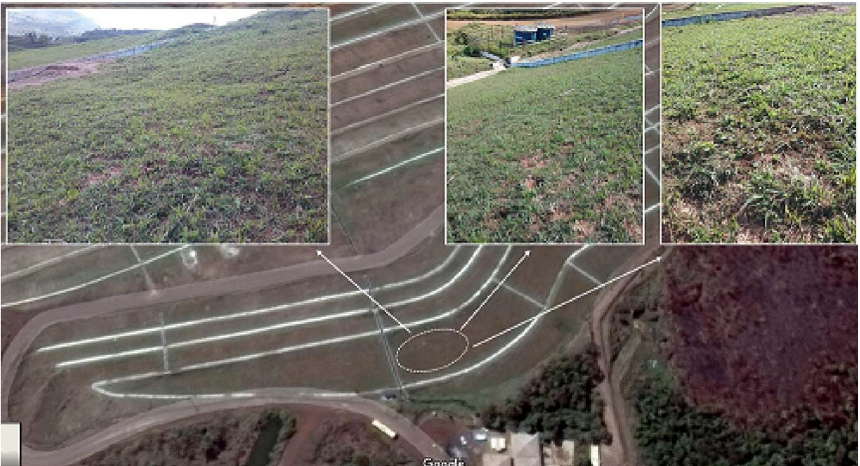
Figura 99: Surgências de água no talude principal
