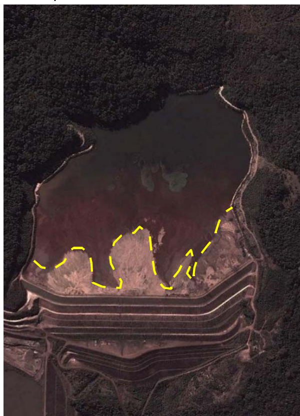
Figura 84: Barragem B I com a praia começando a ser formada em 2012 (linha amarela tracejada), mas ainda com finos perto do barramento
